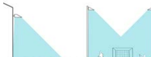
Industri- og idrettsområder: God optisk kontroll på belysningen. Ikke strølys over horisontalplanet. Lysstyring som skur lyset av når området ikke er i bruk.
