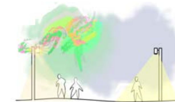
Gangveier: Mastehøyde på 4-5 meter og et 3000K lys. Lysintensiteten reduseres ved høy sannsynlighet for nordlys og en lysende flate på armaturen tennes for å danne en ledelinje
